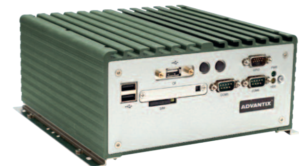
Рис. 2. ER-5000 – расширяемый безвентиляторный компьютер для работы в необслуживаемых помещениях
