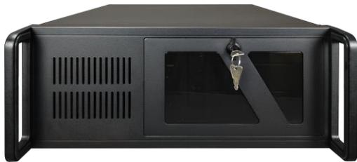
Корпус высотой 4U для монтажа в 19-ти дюймовые стойки. Дверца с замком, запирающаяся ключом. Легкая замена пылевого фильтра через переднюю панель. USB порты спереди. Надежное дополнительное крепление плат расширения в корпусе. Поддержка плат PICMG 1.0 и PICMG 1.3, (возможна замена задней панели для поддержки ATX/mATX плат – заказной код IC-4U-MB-NOLOGO). Малая глубина корпуса.
