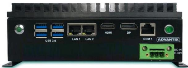
ER-4101 – модель в линейке безвентиляторных компьютеров AdvantiX, имеющая 9-12 COM портов и другие возможности расширения. ER-4101 предназначен для работы при низких и высоких температурах. Поддерживаются 2 независимых цифровых видеовыхода (Dual Head).
