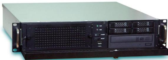
Рабочая станция IPC-2U-SYS9-A9 оптимизирована для монтажа в 19-ти дюймовые стойки, в которых занимает секцию высотой 2U. При этом глубина корпуса составляет всего 460мм. Противопылевой фильтр доступен для замены с передней панели в горячем режиме, как и 2 системных вентилятора 80см. Имеется опция мониторинга открытия корпуса: 3 встроенных датчика вскрытия отслеживают факт открытия верхней крышки корпуса, блока вентиляции и передней дверцы корпуса.
