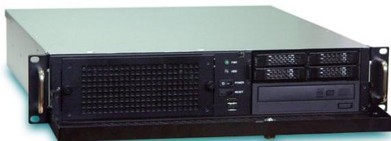
Рабочая станция IPC-2U-SYS9-A10 оптимизирована для монтажа в 19-ти дюймовые стойки, в которых занимает секцию высотой 2U. При этом глубина корпуса составляет всего 460мм. Противопылевой фильтр доступен для замены с передней панели в горячем режиме, как и 2 системных вентилятора 80см. Имеется опция мониторинга открытия корпуса: 3 встроенных датчика вскрытия отслеживают факт открытия верхней крышки корпуса, блока вентиляции и передней дверцы корпуса.
